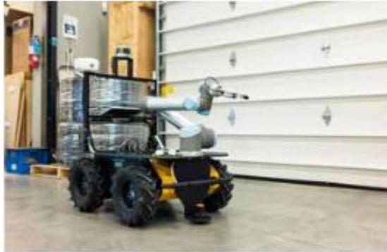
Autonomer Husky Roboter mit UR3 Manipulator / Autonomous Husky robot with UR3 manipulator
