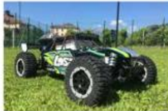
UGV Prototyp zum Test von Navigations- und Kontrollalgorithmen / UGV prototype for tests of navigation and control algorithms
