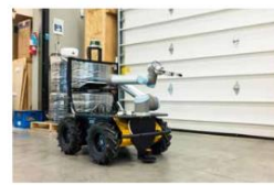
Autonomer Husky Roboter mit UR3 Manipulator / Autonomous Husky robot with UR3 manipulator
